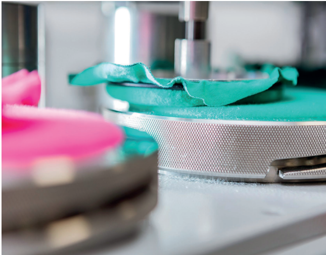
Bild 1. Durch kreisförmige Bewegungen wird in dieser Maschine zur Textilprüfung u.a. die Scheuerfestigkeit geprüft © Forschungsinstitut Hohenstein
