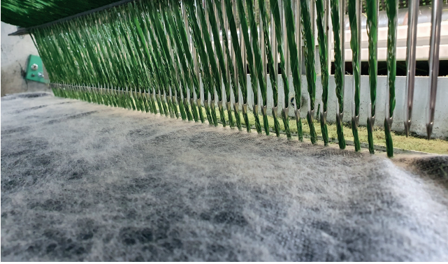
Bild 2. Im Betrieb der Tuftingmaschine am TFI stechen die Nadeln in das Trägermaterial (weiß) und bringen so das Polgarn für den Kunstrasen (grün) ein ©TFI
