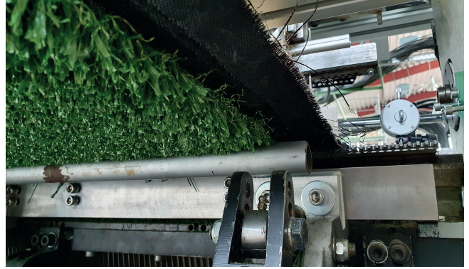
Bild 3. Auslaufbereich der Tuftingmaschine: Der Kunstrasen läuft kopf- über aus der Maschine ©TFI
